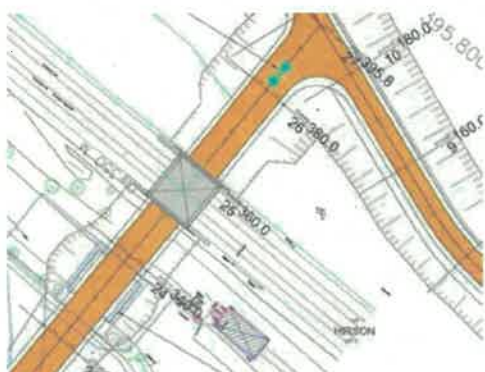
Ouvrage de type cadre sous la voie ferrée de Fives à Hirson.
